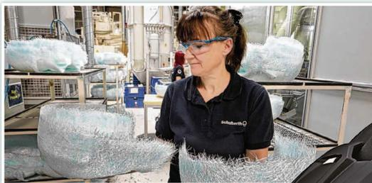
Mitarbeiterin Ellen Schröder mit einer Helmschale, die mit dem Direct-Fiber-Processing-Verfahren hergestellt wurde.
